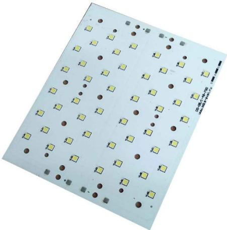
Светодиодный модуль TL-19-48 – плата из фольгированного алюминия TL-19-48, на которой могут быть смонтированы светодиоды Lumileds, Samsung, SEOUL, CREE и др. типоразмера 3030.
