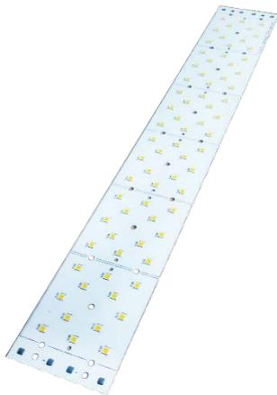
Светодиодный модуль TL-12-72 – плата из фольгированного алюминия TL-12-72, на которой могут быть смонтированы светодиоды Lumileds, Samsung, SEOUL, CREE и др. типоразмера 3030.
